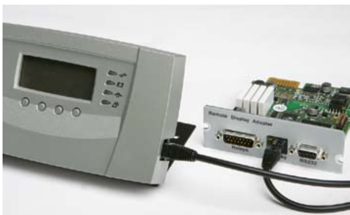
ViewUPS-X wird über eine zugehörige XSlot-Karte angeschlossen
